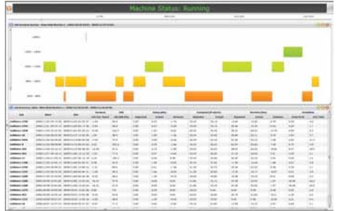
ERP系统工作标准加载到Plantnode,可实时衡量实际工作效率.
